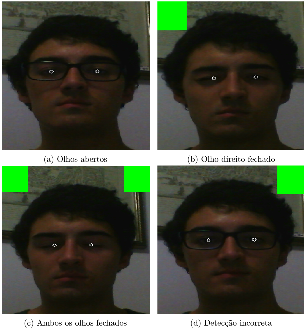
Figura 13 – Detecção de fechamento de olhos. Um quadrado verde é mostrado no lado no qual a piscada é detectada.
