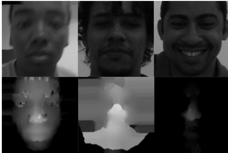
Figura 5.1 Exemplos de problemas em imagem de profundidade causados pela distância, que resultam em ruídos ou dados perdidos.
